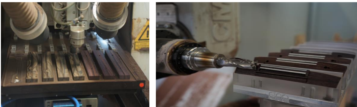
Abbildung 9 Vorfäsen auf der 3-Achs-CNC, finale Bearbeitung auf der 5-Achs CNC
