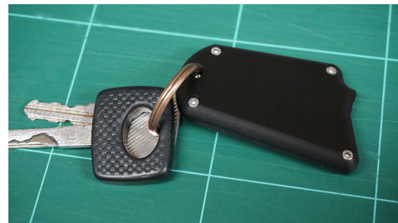
Abb. 5 Fertiges Fernbedienungsgehäuse mit Drückfunktion.
