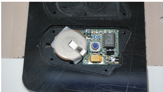
Abb. 4 Probefügen der Elektronik im noch nicht fertigen Bauteil auf der CNC-Fräse.
