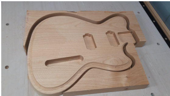
Abb. 4 Herstellung eines Gitarrenkörpers auf der CNC-Fräse – von zwei Seiten gefräst.
